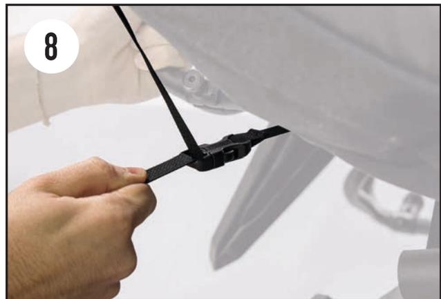
GIVI® consiglia inoltre di ancorare al telaio la cinghia posta nella parte inferiore delle borse come ulteriore precauzione.
