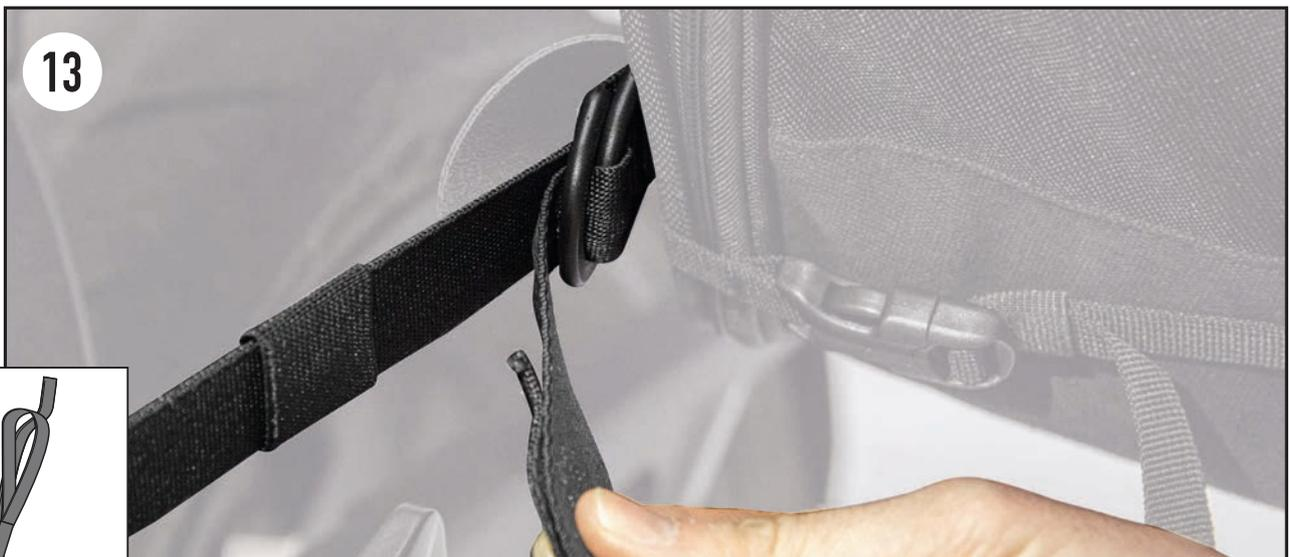
Se non è presente il telaio utilizzare la cinghia con asola, in dotazione, e fissarla al supporto pedana.
